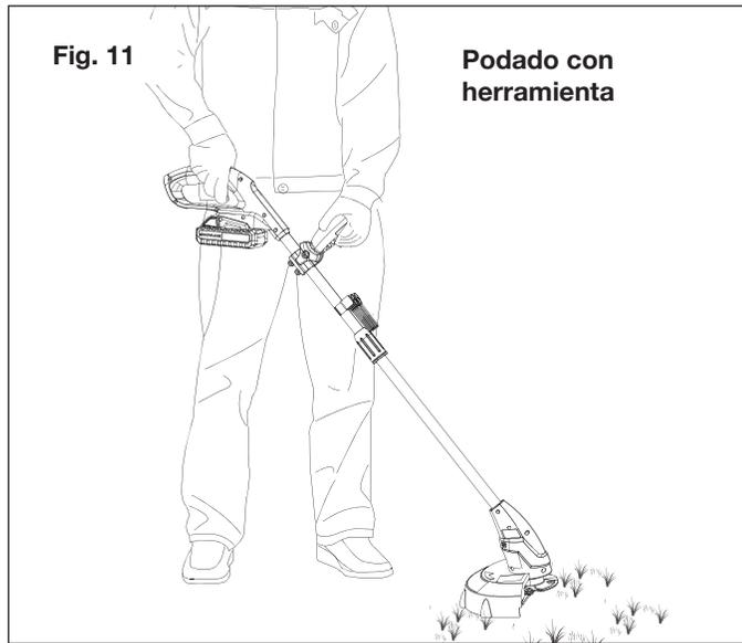
**⚠ ¡ADVERTENCIA!** Siempre sujete la podadora de césped lejos de su cuerpo, manteniendo una distancia de al menos dos pies entre cualquier parte de su cuerpo y el cabezal con accesorio de cuchilla. Cualquier contacto con la cuchilla podadora durante la operación puede causar una lesión personal severa (Fig. 11).
